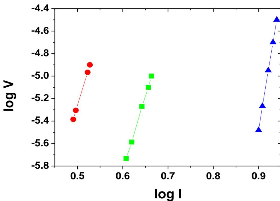
شکل ۷. نمودار  $\log V$ - $\log I$  برای نمونه آلیش داده شده با  $Pb$  و  $Sb$  به مقدار  $y = 0.05$  و  $x = 0.25$  با زمان‌های پخت  $150$  (■)،  $210$  (●) و  $270$  (▲) ساعت
