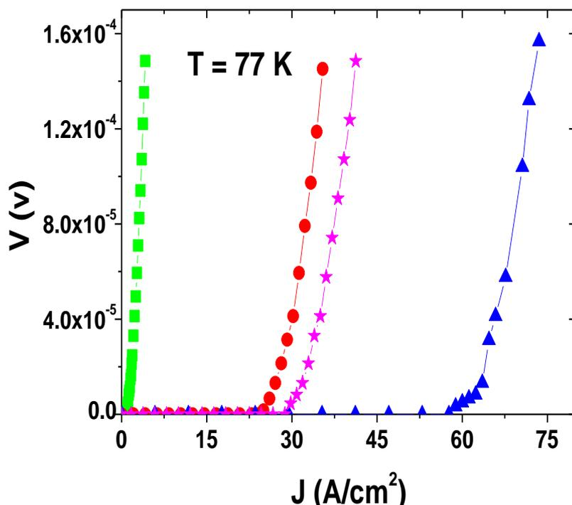
شکل ۳. نمودارهای  $V$ - $J$  برای مقادیر متفاوت  $Pb$  و  $Sb$ :  $(\square)$  ۰٫۰۴،  $(\bullet)$  ۰٫۳۶،  $(\circ)$  ۰٫۰۵،  $(\blacktriangle)$  ۰٫۳۵ و  $(\blacktriangle)$  ۰٫۰۸،  $(\star)$  ۰٫۳۲ با زمان پخت ۲۷۰ ساعت
