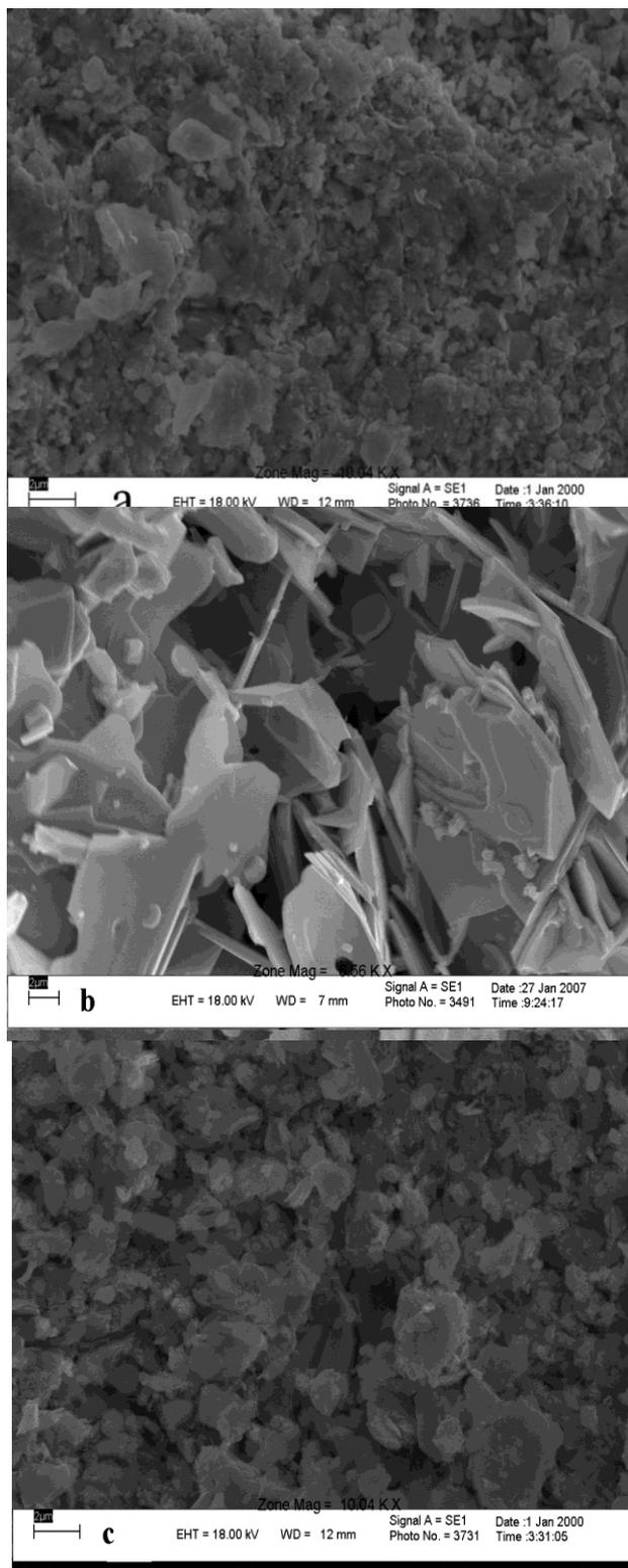
شکل ۱۰. (a)–(c) تصویرها SEM برای نمونه‌ها با مقدار آنتیموان و سرب ۰٫۴۰ ، ۰٫۵۰ ، (a) ۰٫۳۵ ، ۰٫۲۰ و (b) ۰٫۲۰ ، ۰٫۳۵ ، (c) با زمان پخت ۲۷۰ ساعت.
