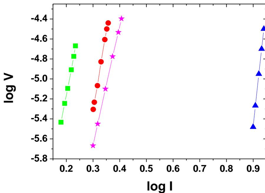
شکل ۶. نمودار  $\log V$ - $\log I$  برای نمونه‌های آلیش داده شده با مقادیر مختلف  $Pb$  و  $Sb$ :  $0.02$  (■)،  $0.28$  (▲) و  $0.05$  (★)،  $0.10$ ،  $0.30$  (●) و  $0.20$ ،  $0.20$  با زمان پخت  $270$  ساعت.
