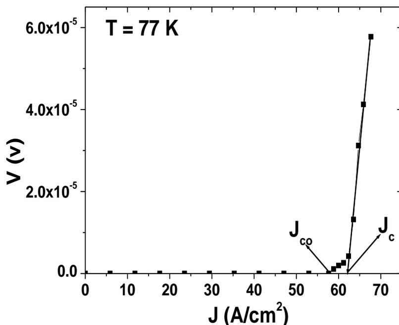
شکل ۵. نمودار  $V-J$  برای نمونه‌ی آلیش داده شده با  $Pb$  و  $Sb$ ،  $x = 0.35$  و  $y = 0.05$  با زمان پخت ۲۷۰ ساعت.
