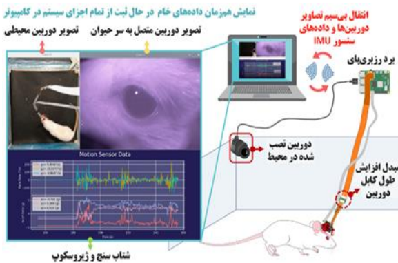
شکل ۲۲: انتقال بی‌سیم و نمایش همزمان تصاویر دوربین‌ها و داده‌های حسگر IMU از برد رزبری پای به کامپیوتر.
