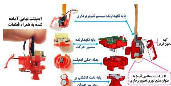
شکل ۸: شماتیک طراحی سه بعدی و قطعات ساخته شده.
