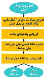
شکل ۷: محاسبه مرکز و شعاع مردمک با استفاده از DLC.
