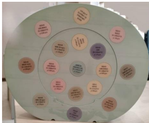
شکل ۱۰. فانتوم ناهمگن استاندارد، ساخت کمپانی CIRS آمریکا.
