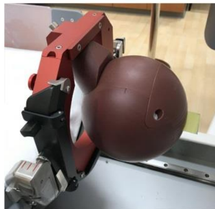
شکل ۶. فانتوم مورد استفاده جهت اعتبارسنجی و نحوه تابش‌دهی
