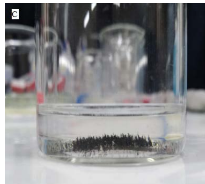
شکل ۲: تصاویر میکروسکوپ روبشی الکترونی (FESEM) نانوسیم‌های مغناطیسی آهن ساخته شده با روش الکتروانباشت (B و A). نانوسیم‌های مغناطیسی آزاد شده در غیاب میدان مغناطیسی (C).
