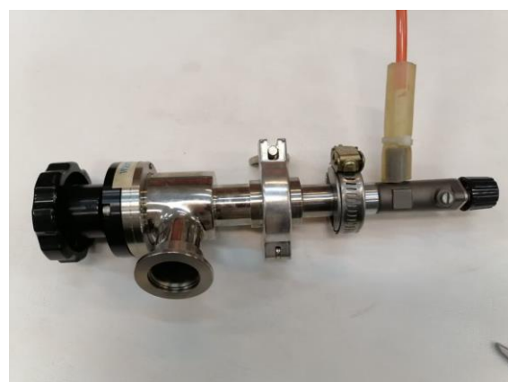
شکل ۳: سیلندر عایق طراحی شده برای جمع‌آوری گاز
