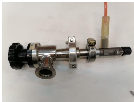
شکل ۳: سیلندر عایق طراحی شده برای جمع‌آوری گاز
