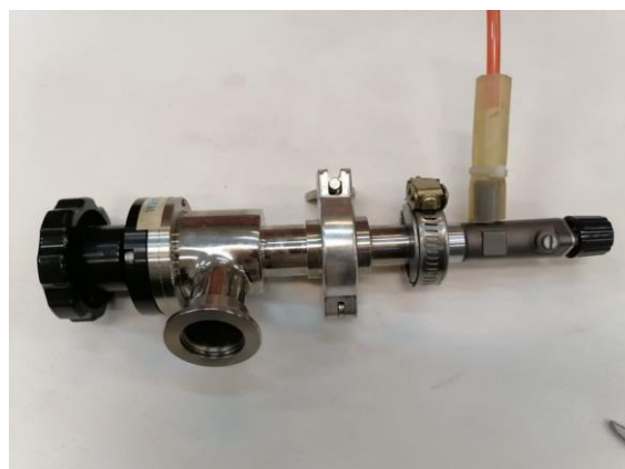
شکل ۳: سیلندر عایق طراحی شده برای جمع‌آوری گاز
