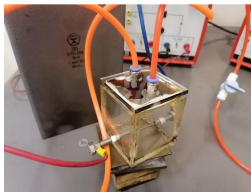
شکل ۱: نمای راکتور و الکتروودها
