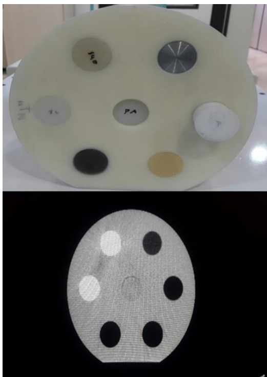
شکل ۳. تصویری از فانتوم ساخته شده. بالا: نمایی از فانتوم ساخته شده، پایین: تصویر سی تی فانتوم ساخته شده.
