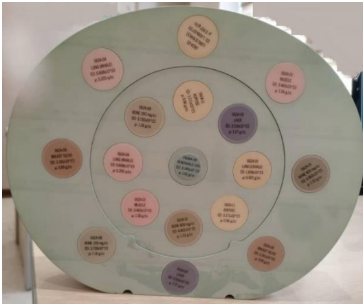
شکل ۱. تصویر فانتوم مرجع متشکل از چندین ناخالصی با چگالی‌های الکترونی متفاوت، ساخت شرکت CIRS آمریکا مدل M۰۶۲.
